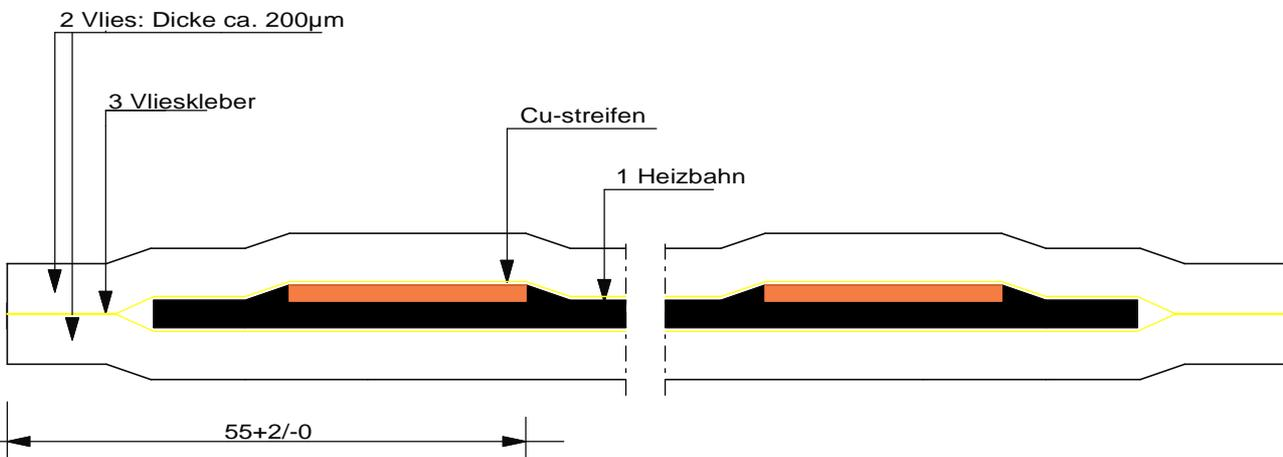
Heizbahn 1 Dicke: ca. 400 µm im Bereich der Kupferstreifen ca. 460 µm
