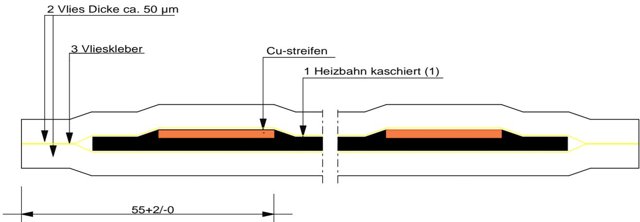
Heizbahn 8 Dicke: ca. 500 µm, im Bereich der Kupferstreifen ca. 570 µm
